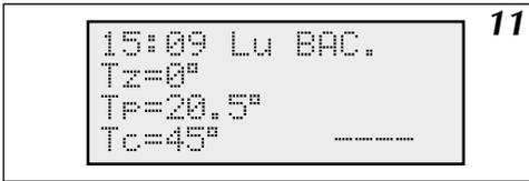
Figure 11 Vue générale en configuration „C.C.NON BAC. OUI” (Mode chauffage central débranché, mode e.c.s. Inclus)
